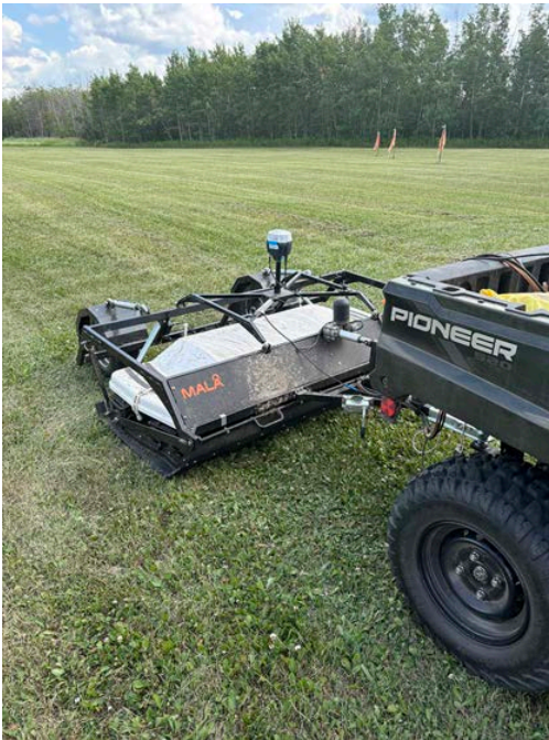
Un radar pénétrant Mala Mira avec imagerie à étendue dynamique élevée multicanal remorqué dans la zone de recherche (à gauche) et un dispositif de spectroscopie du sol S4 Subterra Gray (à droite) lors d'une recherche sur le terrain en 2024 (Bureau de l'interlocutrice spéciale indépendante).
