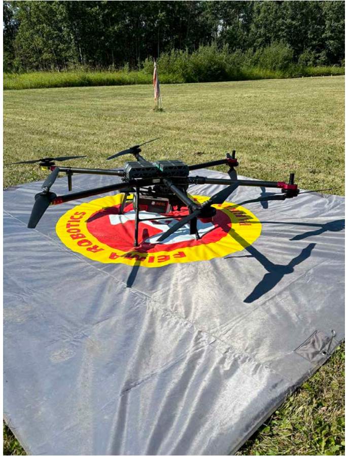
Drone FEMIA Robotics D20 avec capteur lidar Riegl VUX-120 lors d'une recherche de site en 2024. (Bureau de l'interlocutrice spéciale indépendante)
