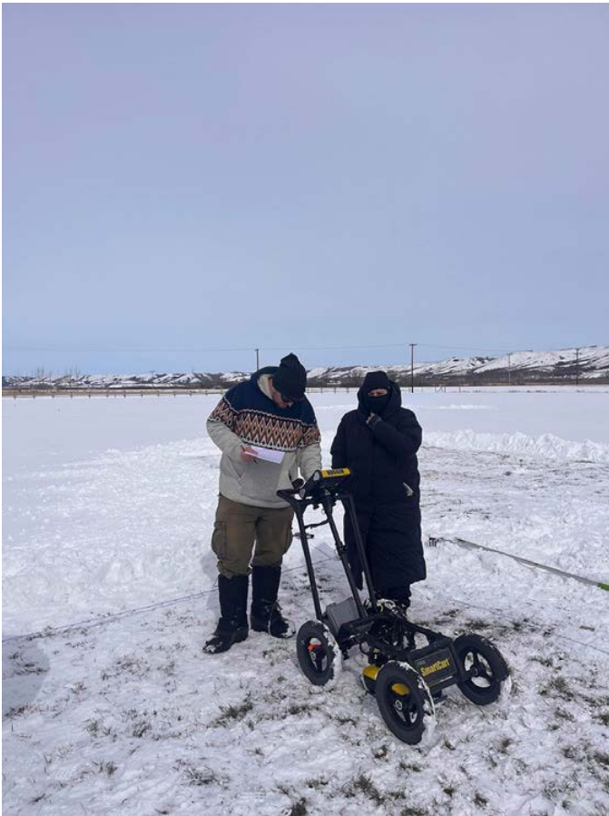
Les archéologues Joshua Murphy (à gauche) et Micaela Champagne (à droite) vérifient un radar pénétrant GPR à la recherche d'anomalies et de pénétration du signal dans des conditions enneigées sur le site de l'ancien pensionnat indien de Marieval, Première Nation de Cowessess, hiver 2022 (photo fournie par Micaela Champagne).
